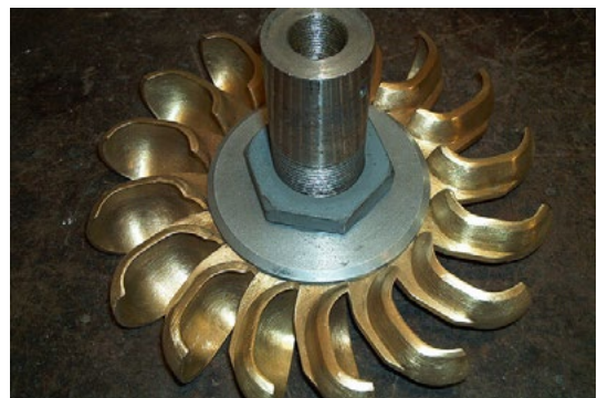
Patín de la turbina modelo Watermotor 150. Diámetro de 15 cm.
