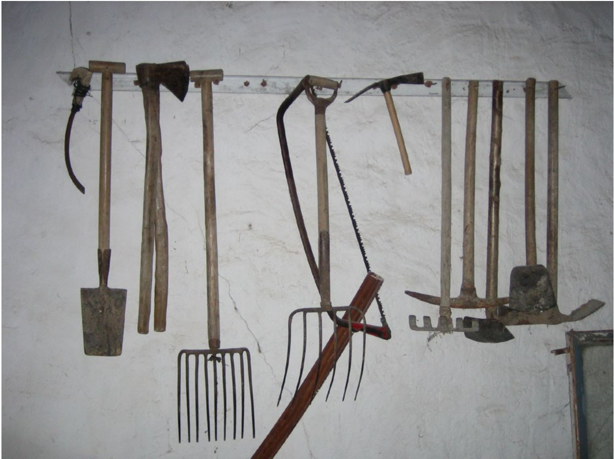
Aperos tradicionales: hoz, pala, hachas, horcas, sierra, zuela, hacha alcotana o hachazada, rastrillo, pico, azadas. Cuenca, España 71 .
